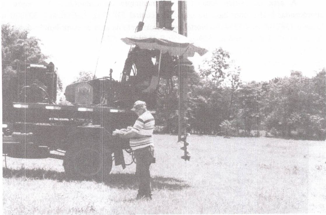
Figura 3. Caminhão perfuratriz (trado mecânico-hidráulico).
