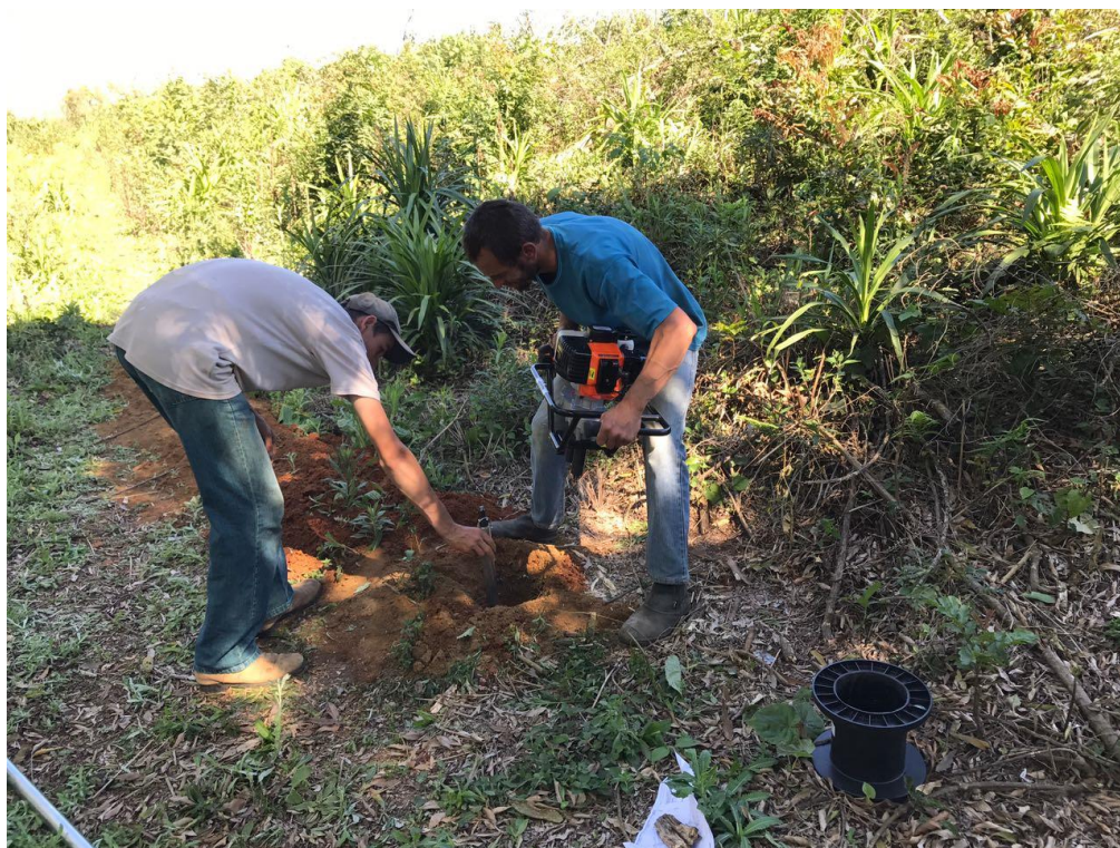
Fotografia 11: Trabalhos de Campo - Furo de sondagem 5 com 5 metros de profundidade.
