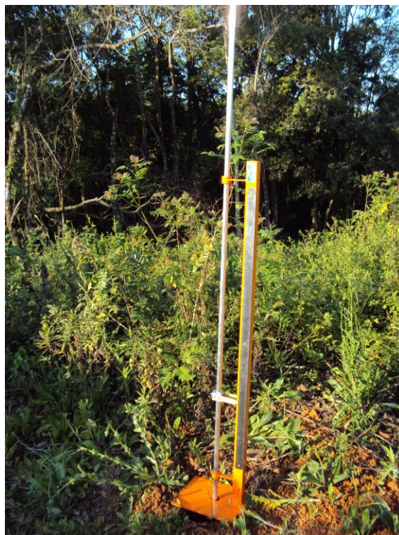
Fotografias 21 e 22: Trabalhos de Campo- Teste de Permeabilidade do Solo – Furo 4 com 1,5 metros de profundidade.
