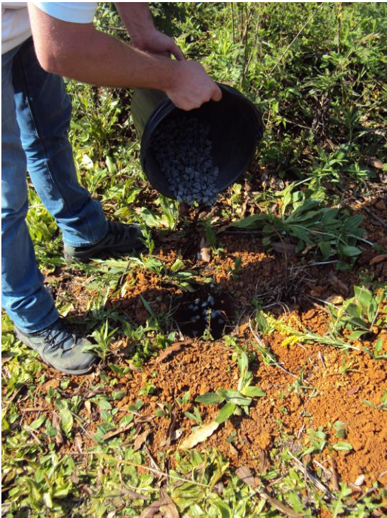
Fotografias 17 e 18: Trabalhos de Campo- Teste de Permeabilidade do Solo – Furo 3 com 1,5 metros de profundidade.
