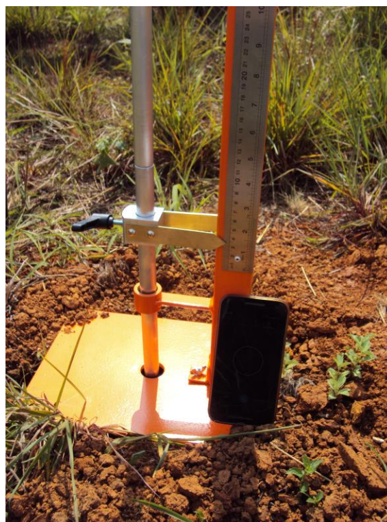
Fotografias 13 e 14: Trabalhos de Campo- Teste de Permeabilidade do Solo – Furo 1 com 1,5 metros de profundidade.
