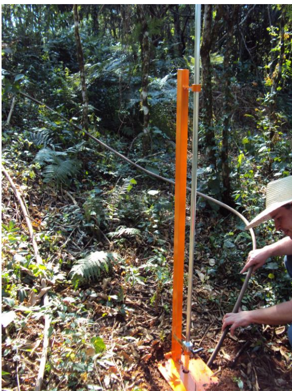
Fotografias 19 e 20: Trabalhos de Campo- Teste de Permeabilidade do Solo – Furo 4 com 1,5 metros de profundidade.
