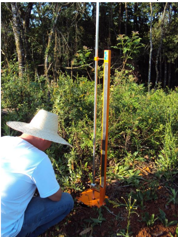
Fotografias 21 e 22: Trabalhos de Campo- Teste de Permeabilidade do Solo – Furo 4 com 1,5 metros de profundidade.
