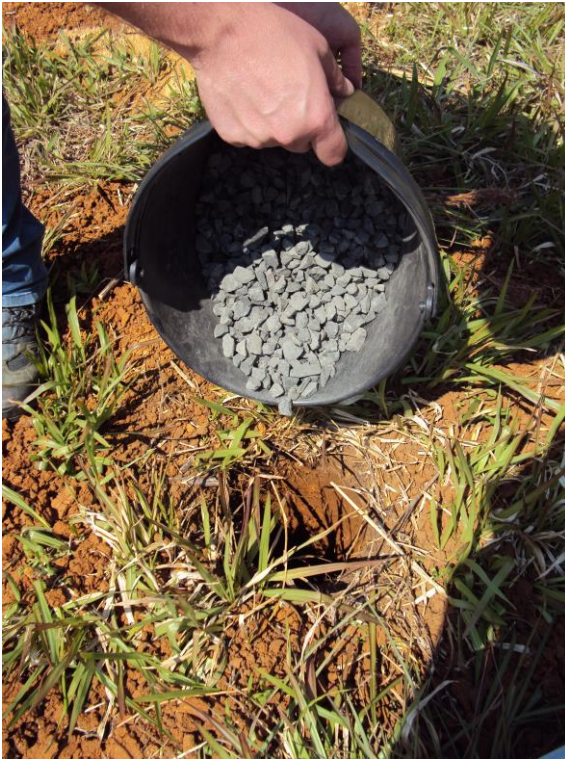
Fotografias 15 e 16: Trabalhos de Campo- Teste de Permeabilidade do Solo – Furo 2 com 1,5 metros de profundidade.
