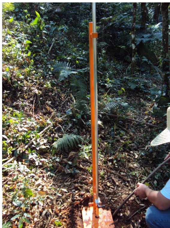
Fotografias 19 e 20: Trabalhos de Campo- Teste de Permeabilidade do Solo – Furo 4 com 1,5 metros de profundidade.
