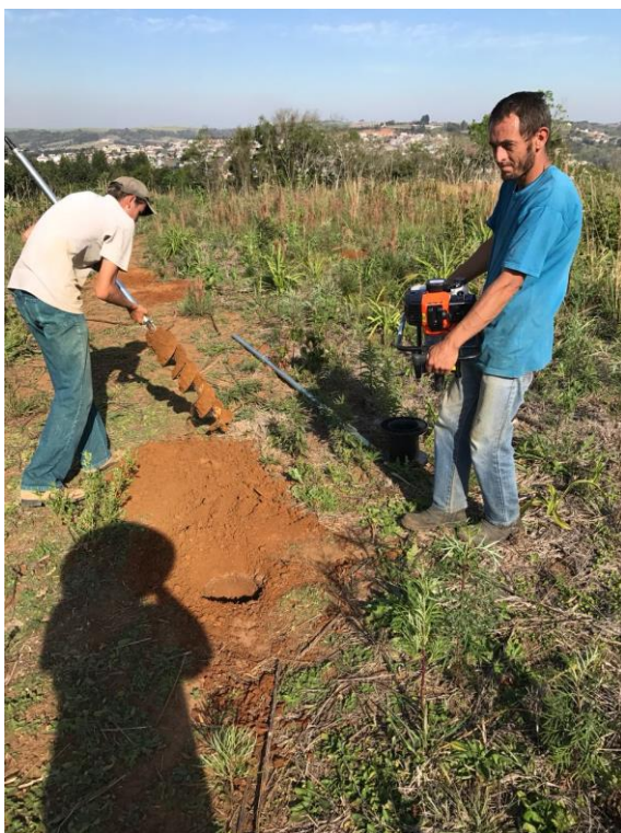
Fotografias 7 e 8: Trabalhos de Campo - Furo de sondagem 2 com 3,5 metros de profundidade.
