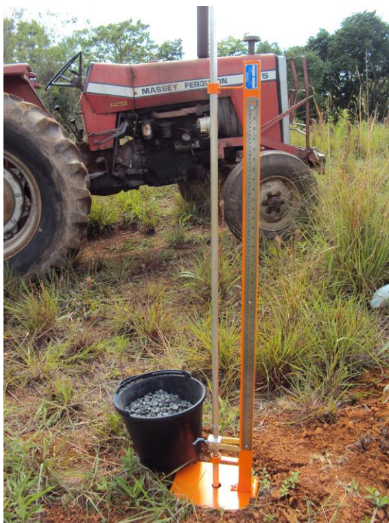
Fotografias 13 e 14: Trabalhos de Campo- Teste de Permeabilidade do Solo – Furo 1 com 1,5 metros de profundidade.
