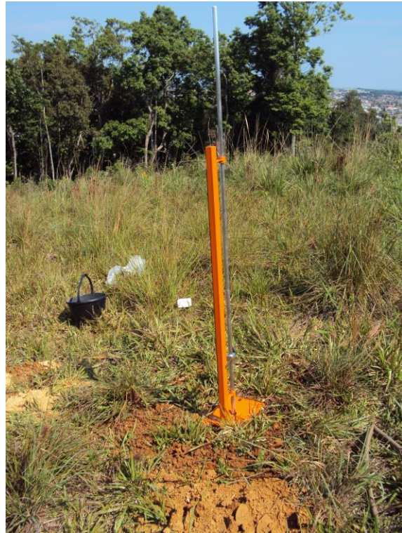
Fotografias 15 e 16: Trabalhos de Campo- Teste de Permeabilidade do Solo – Furo 2 com 1,5 metros de profundidade.
