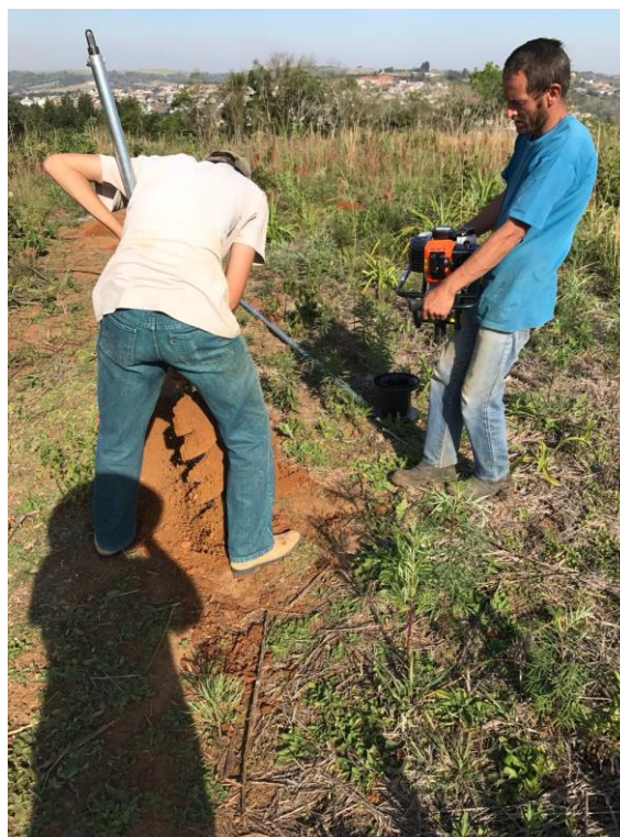
Fotografias 7 e 8: Trabalhos de Campo - Furo de sondagem 2 com 3,5 metros de profundidade.
