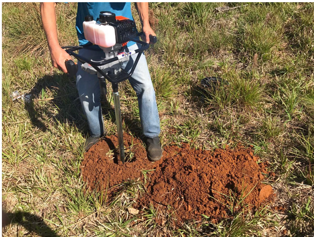
Fotografia 6: Trabalhos de Campo - Furo de sondagem 1 com 5,5 metros de profundidade.
